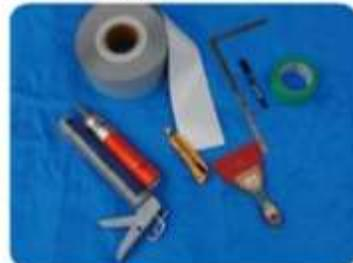
上段左から陸置型テープ（幅10cm）、曲尺（差金）、油性ペン、マスキングテープ 下段左からコーキングガン、シーリング材、カッターナイフ、ゴムペラ
