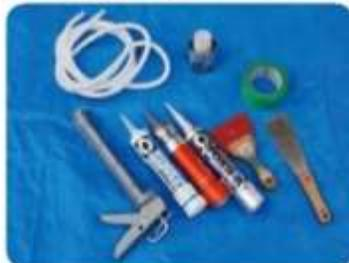
上段左からバックアップ材、プライマー（塗着剤）、マスキングテープ 下段左からコーキングガン、シーリング材（左よりシリコン系、ポリウレタン系、変成シリコン系）、ゴムペラ、金ペラ
